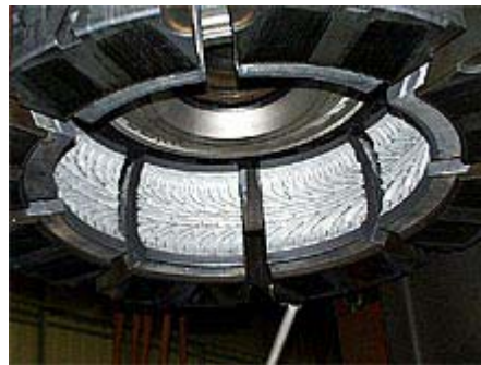
Figura 3.3.1 Tipo de molde separado en ocho partes, en el cual cada segmento trabaja a presión
