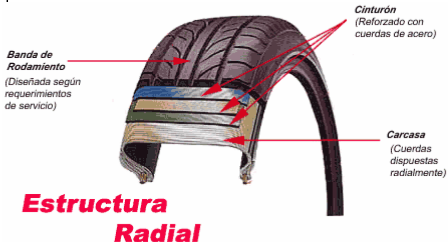
Figura 1.1 Partes del neumático radial
