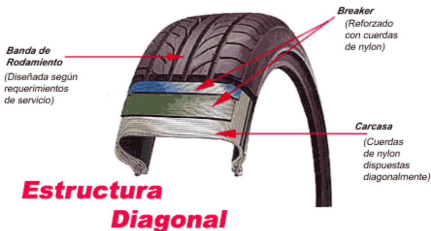
Figura 1.2 Partes del neumático diagonal
