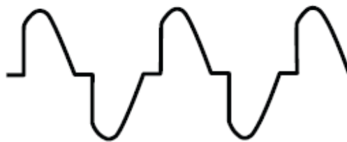
Figura 3.- Atenuador tipo corte de fase de la forma de onda de salida
